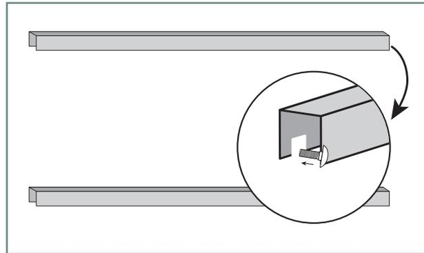
1. Wenn Ihr Bettkopfteil mit einer U-Profil Aufhängung bestellt wurde, dann kleben Sie das mitgelieferte Profil mit der Öffnung nach unten und mit dem nötigen Abstand nach oben auf der Plattenrückseite fest.
