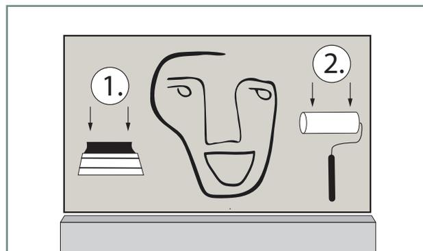
5. Die Tapete zuerst mit einer festen Bürste oder Rakel und anschließend noch mit einer Gummivalze glattstreichen.
