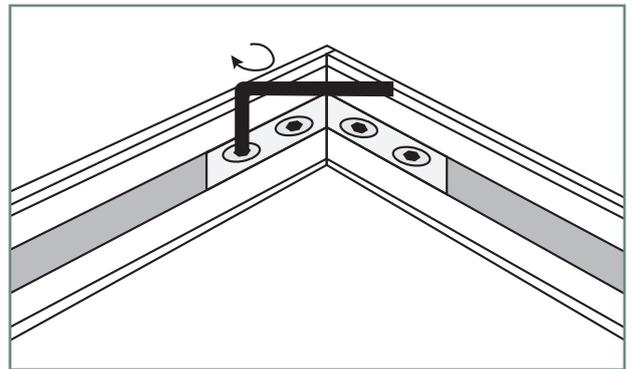
4. Wenn die beiden Profile exakt an der Kante platziert sind, schrauben Sie die 4 Schrauben mittels Inbusschlüssel fest.
