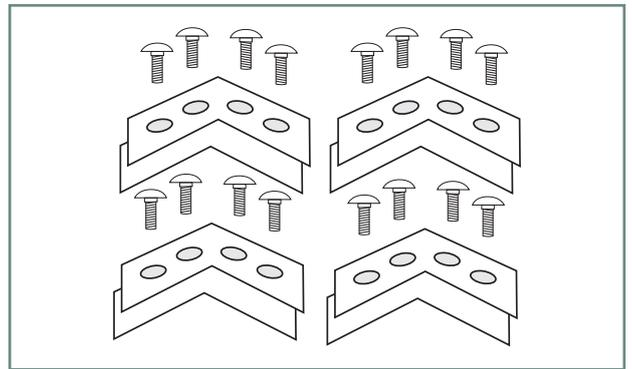
2. Nehmen Sie die 4 Winkelpaare - jeweils ein Winkel mit Schrauben und einer ohne Schrauben. Der Winkel mit den Schrauben schaut nach oben.
