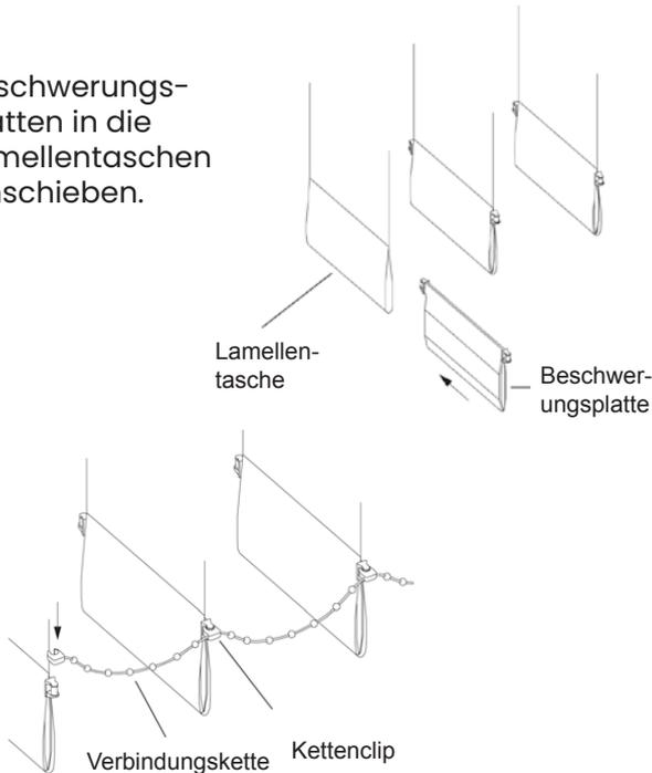
Die Kettenclips der Verbindungskette auf die vorderen Halter der Beschwerungsplatten aufstecken.
