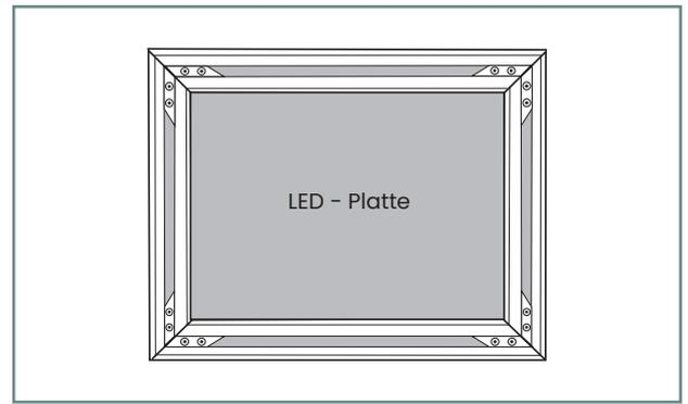
6. Schrauben Sie den fertigen Rahmen nun an die Decke. Je nach Größe der Lichtdecke ist es ratsam auch die LED Platte zwischen den Lichtpunkten an die Decke zu schrauben.
