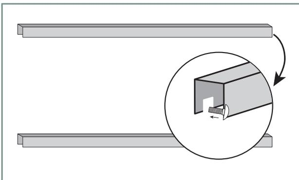
1. Wenn Ihr Glasbild mit einer U-Profil Aufhängung bestellt wurde, dann kleben Sie das mitgelieferte Profil mit der Öffnung nach unten und mit dem nötigen Abstand nach oben auf der Plattenrückseite fest.
