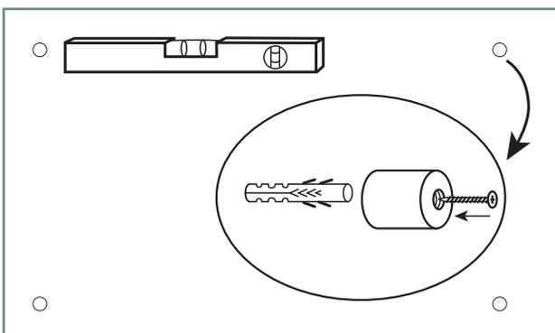
1. Wenn Ihr Metallbild mit Abstandhaltern befestigt wird, dann halten Sie das Bild mit Hilfe einer Wasserwaage an den gewünschten Platz. Markieren Sie die 4 Löcher an der Wand, bohren die 4 Löcher und schrauben Sie die Abstandhalter fest.
