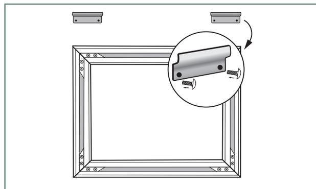
6. Hängen Sie den fertigen Rahmen nun an die Wand (durch Schrauben oder Einhängen).
