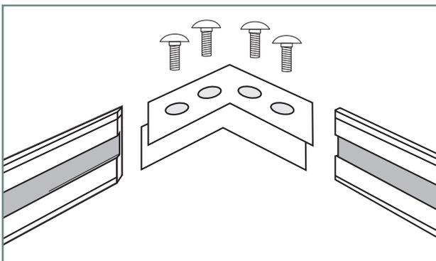
3. Führen Sie das Winkelpaar in ein Profil ein und stecken Sie ein zweites Profil dazu, sodass Sie nun 2 Profilstangen im rechten Winkel zueinander haben.
