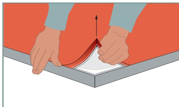
8. Halten Sie den Stoff mit der Gummilippe nach unten an den Rahmen und beginnen Sie die Gummilippe an einer Ecke in den Schlitz einzudrücken. Bitte fügen Sie den Stoff immer an den gegenüberliegenden Ecken ein (diagonal). Wenn alle vier Ecken der Kunststoffleisten eingepasst sind, drücken Sie den Stoff entlang des Rahmens zur Mitte hin in die Nut. Dies ist wichtig, damit sich die Spannung des Stoffes gleichmäßig verteilt und keine Falten entstehen.
