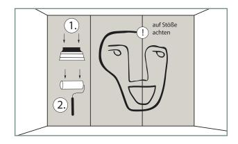
5. Zuerst mit einer festen Bürste oder Rakel und anschließend noch mit einer Gummiwalze feststreichen.
