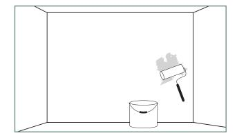
3. Bringen Sie dann den Kleber mittels einer Lammfellwalze satt und gleichmäßig auf die Wand auf.
