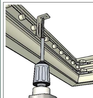
Befestigen Sie den Rahmen durch Verschraubung an der Decke.
