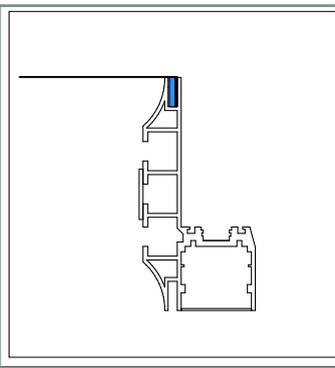
Korrekt eingeschlagen wird nun das Tuch samt Gummilippe in die dafür vorgesehene Nut nahe der Rahmenkante gedrückt.
