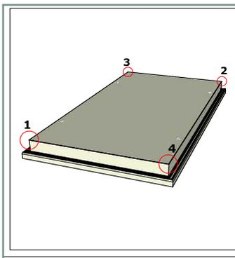
Da Textildruck im Regelfall etwas Stretch besitzt, ist es ratsam für ein möglichst unverzerrtes Bild an den Ecken zu beginnen und über Kreuz zu arbeiten.
