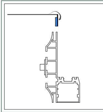
Die Kante des Stoffes wird nun so um 90° eingeschlagen, dass sich die **Gummilippe auf der Innenseite** (Also von der Sichtfläche abgewandt) **befindet**.
