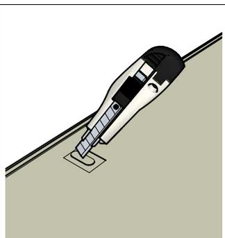
In dem nun eingespannten Blockout sollten sich rückseitig die Montagewinkel abzeichnen.
