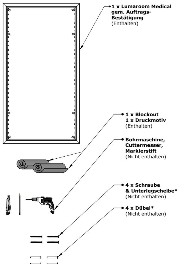
\*Dübel, Schrauben und Unterlegscheiben sind vom Monteur passend für die Montagegegebenheiten zu wählen.
